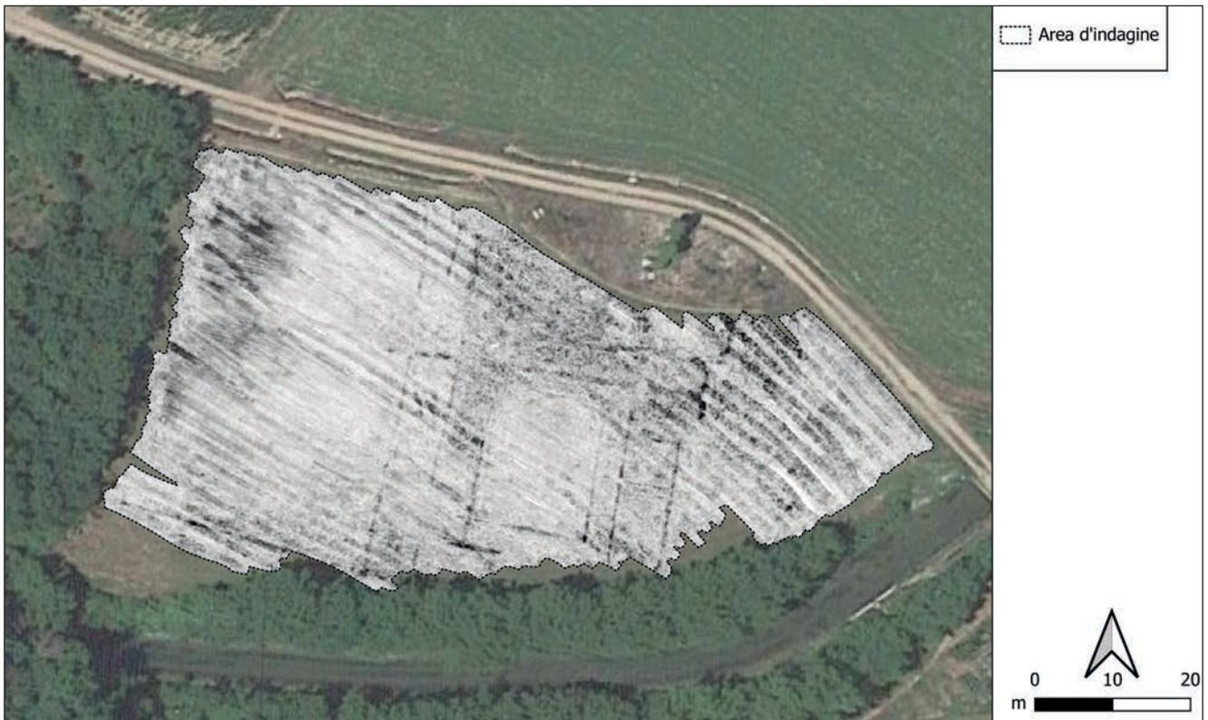
Fig. 51. Cervere. Resti del monastero di S. Teofredo. Restituzione dei dati georadar su foto satellitare (elab. F.T. Studio s.r.l.).
